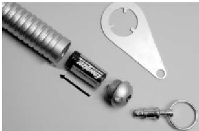
图7-数据下载器电池安装
